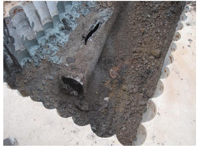
Das Rohr, das unter der Betonplatte zum Vorschein kam, wies schwere Korrosionsschäden auf.
