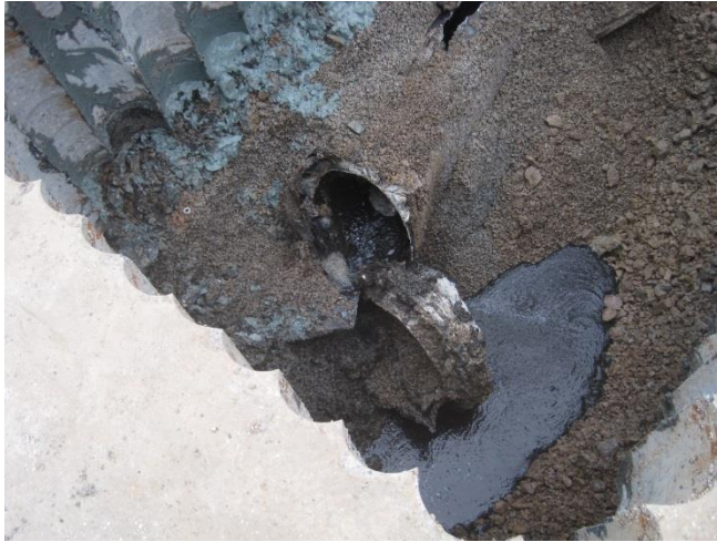
Das Rohr, das unter der Betonplatte zum Vorschein kam, wies schwere Korrosionsschäden auf.
